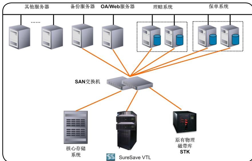
SureSave VTL1000采用智能扩展引擎，可以实现多任务并发，本项目中配置2个并行控制器（VTL1000最大可扩展到16个并行控制器），前端4个4Gb/s的光纤接口，16TB的实际可用容量，虚拟成4个驱动器、32个槽位。原有的STK物理磁带库作为归档设备直接连接SureSave VTL后端归档专用接口，实现数据的离线保存。
